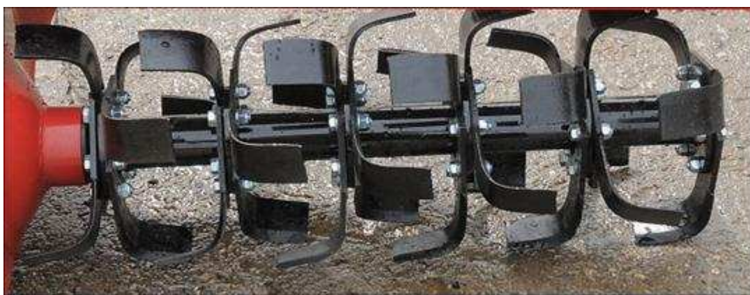
Slika 8. Raspored noževa na rotoru
