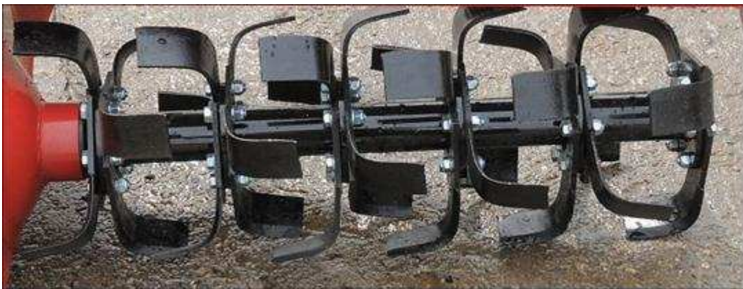
Slika 8. Raspored noževa na rotoru
